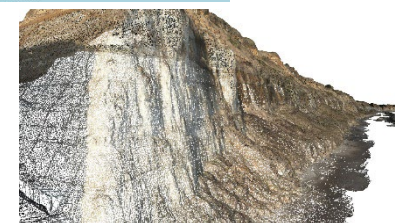
UAV(ドローン)による航空測量による3D画像 (名勝及び天然記念物屏風ヶ浦保存活用計画より)
