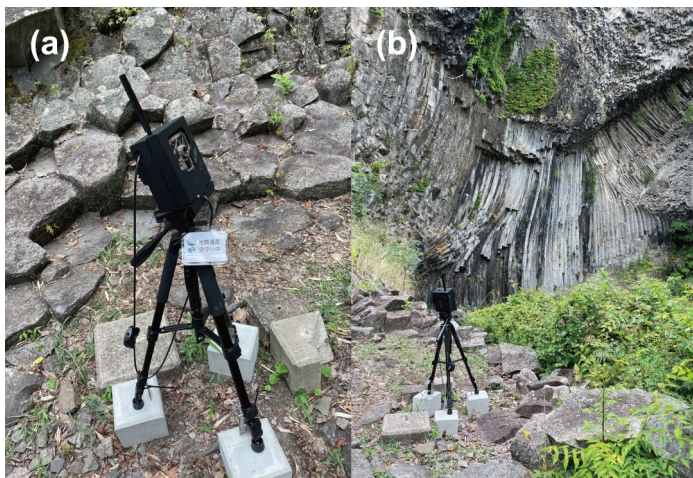
図2 レイルカメラを玄武洞公園に設置している様子. (a) 設置時のトレイルカメラの近接写真. カメラには盗難防止用のカバーを着けている. カメラに取り付けた三脚とコンクリートブロックは結束バンドで固定した. 訪れた観光客に不信に思われないように「地質遺産見守り中」と書いたタグを取り付けている. (b) 設置したカメラの周辺の様子.
